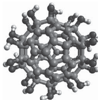
図5 フラーレン誘導体 C_{60}(OH)_{24} の構造 (白球：水素H、灰球：炭素C、黒球：酸素O)
